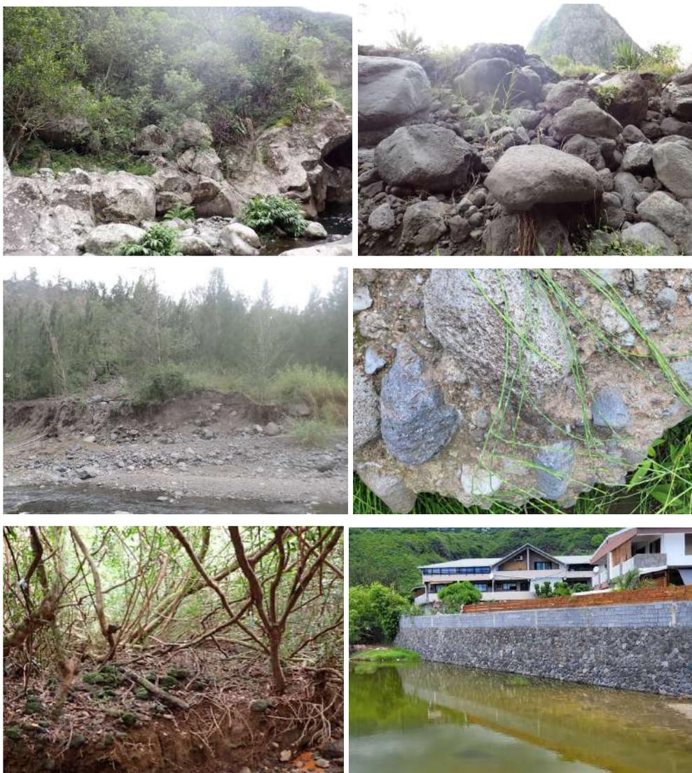
Figure 9 : Matériaux constitutifs des berges : [a]minéral à roche mère; [b]minéral à blocs non liés; [c]alluvial non cohésif; [d]alluvial cohésif; [e]terre végétale; [f]anthropique © A. Piteau, C. Meriel
